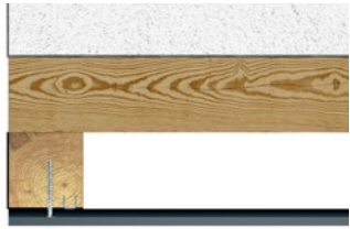
Bündige Montage der Fassadenplatten an der Fensterlaibung
